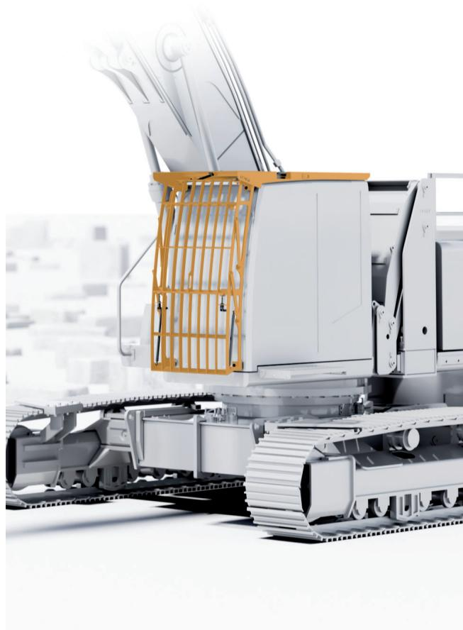
Für Arbeiten, bei denen kein FOPS vorgeschrieben ist, lässt sich das Frontschutzgitter mit gasdruckfederunterstütztem Schwenkmechanismus aus dem Hauptsichtbereich entfernen. So wird bei ungefährlichen Arbeiten eine freie Sicht innerhalb weniger Sekunden ermöglicht.
